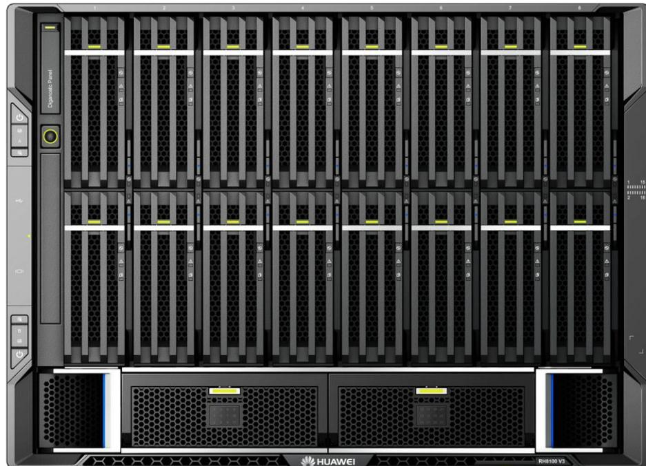
图 1-3 所示的前面板中，B 型前 IO 模块是由左右两个硬盘抽屉组成的，每个抽屉各包括 12 个 2.5 英寸硬盘槽位，所以 FIOM-B 最多可以支持 24 个硬盘槽位。可以参考 1.5.2 前 IO 模块小节的介绍。
